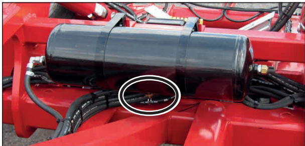
Ilmasäiliö ja vedenpoistovenkki
