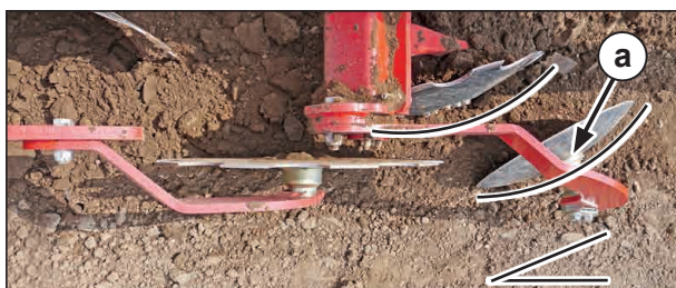
Úhlové postavení odklízecího talíře
