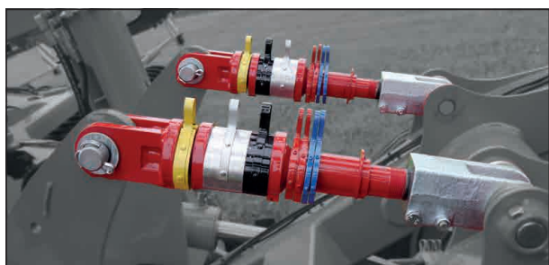
Säätötangot pidikkeiden kanssa (pakkeri)
