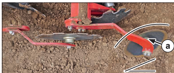
Úhlové postavení odklízecího talíře
