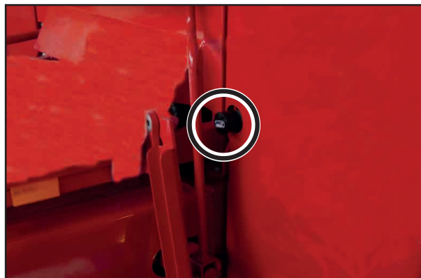
Käyttöpainike pneumaattisen jarrun vapauttamiseksi
