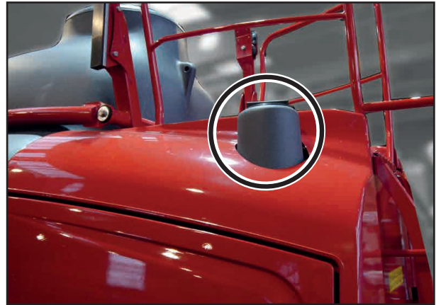
Säiliön kansi ja puhdasvesisäiliön ilmanpoisto
