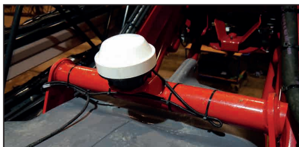
GPS-vastaanotin poikkituen aluslevyn päällä
