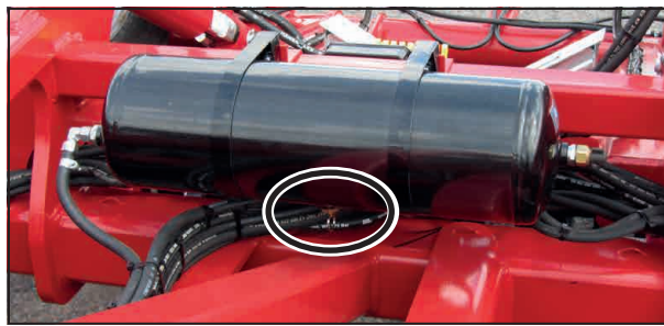
Ilmasäiliö ja vedenpoistovenktiili
