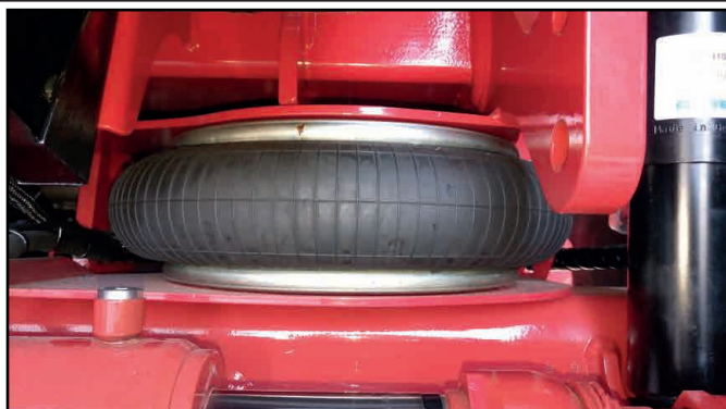
Kuva 1.3: Etäisyys paljelaippalevyjen välissä 135 mm \pm 10 mm
