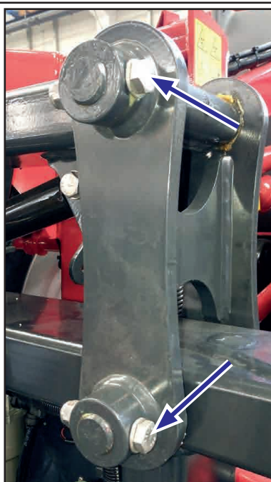
Kuva 3.26: Tarkasta keskirungon ja heiluri-ikeen välinen liitântä muodonmuutosten varalta; Tarkasta ruuvien tiivis paikoillaanolo
