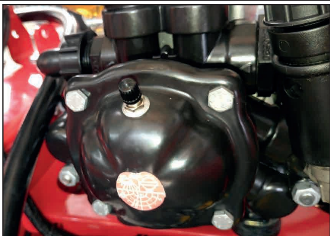
Kuva 4.13.1: Tarkasta tuulikattilapaine, tavoitepain 5 bar
