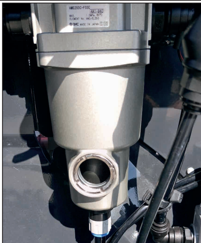
Kuva 3.42: Poista vesi vedenerottimesta
