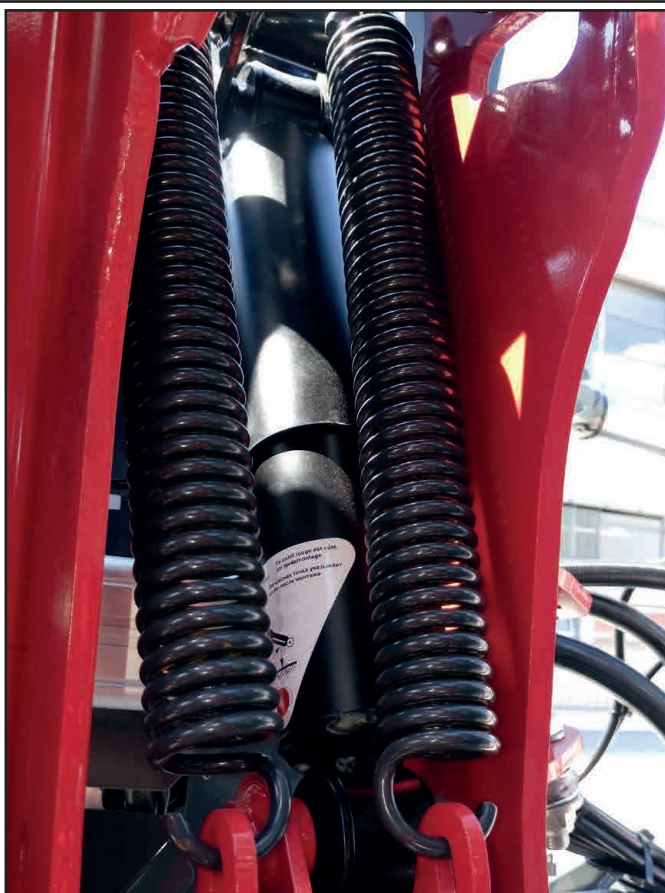
Kuva 3.32: Tarkasta vaakasuoran vaimennuksen vetojouset ja iskuvaimentimet
