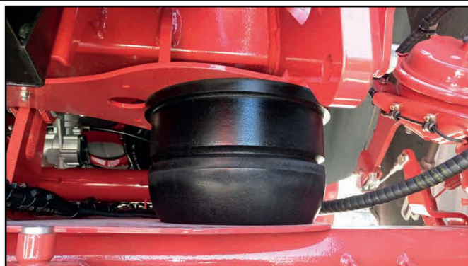
Kuva 1.4: Tarkasta Vulkocell-jousi vaurioiden/kulumien varalta
