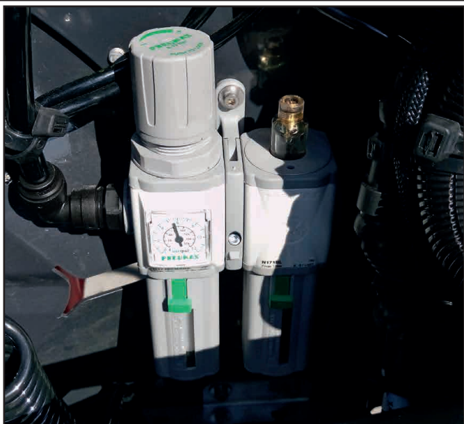
Kuva 3.43: Tarkasta paineenalentimen säätö
