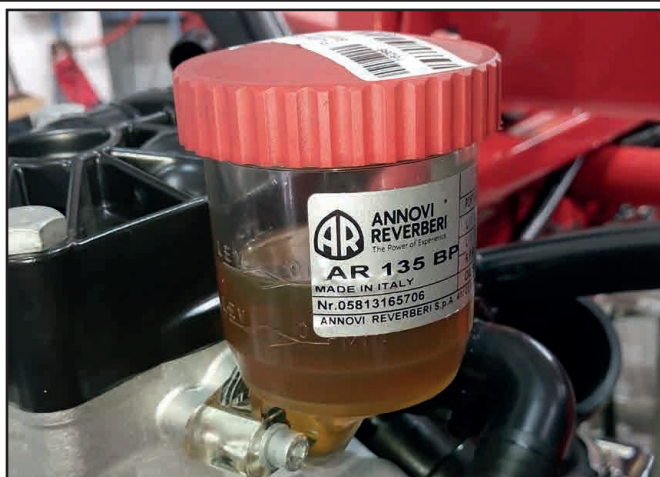
Kuva 4.13.2: Tarkasta öljynpaine tasoitussäiliössä
