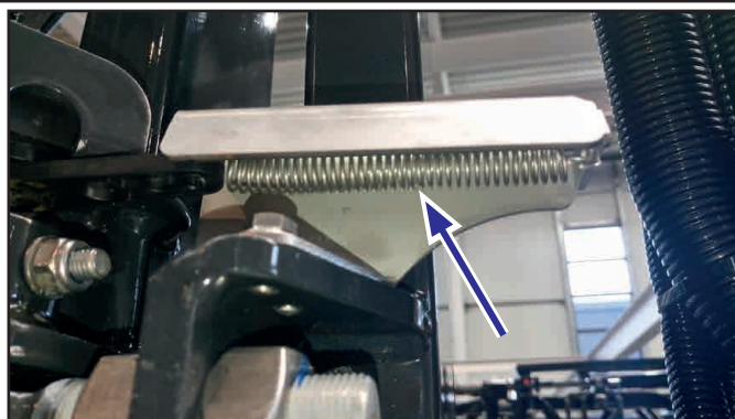
Kuva 3.9: Tarkasta jousen vauriot ja suora veto
