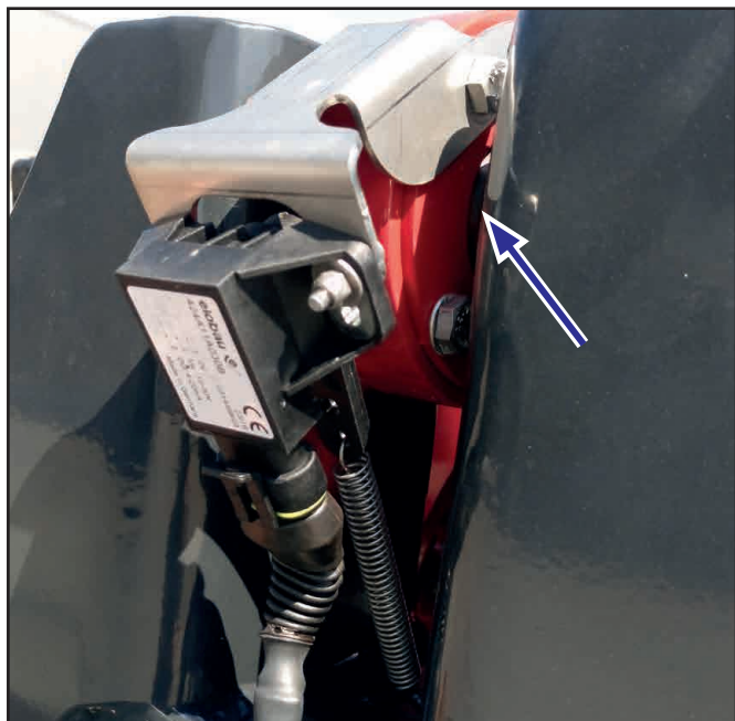
Kuva 3.29: Tarkasta heilurinivelsilmän kiinnitys ja kuluminen
