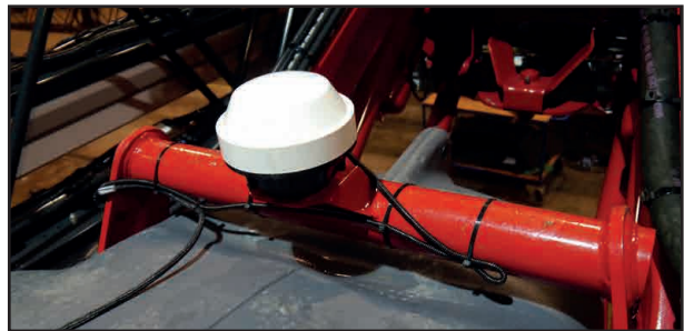
GPS-vastaanotin asennettuna poikkipalkin kannatinlevylle
