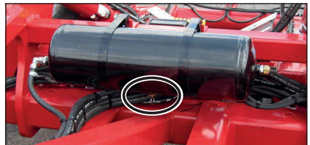
Ilmasäiliö ja vedenpoistovenktiili
