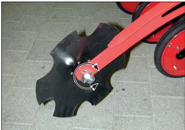
Ennakkomerkintälaitteet - kiekkojen aggressiivisuuden mukauttaminen
