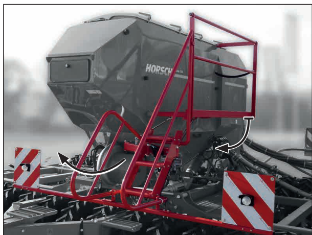
Nousutikkaat/työskentelytaso kaksoissäiliöllä varustetussa Pronto 6 DC -koneessa
