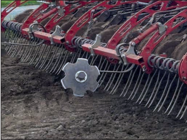
Ennakkomerkitälaite raskaalle äkeelle
