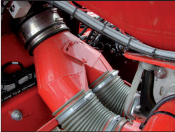
Jakoputki ja ilmaläppä
