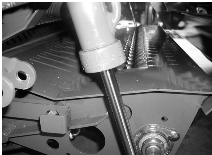
Kuva 10.d - Tukoksenpoistotila, terät vetäytyneinä ja kuilun pohja laskettuna
