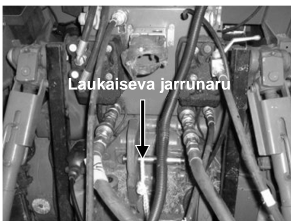
Kuva 9.b - Laukaiseva jarrunaru kiinnitetynä traktoriin
