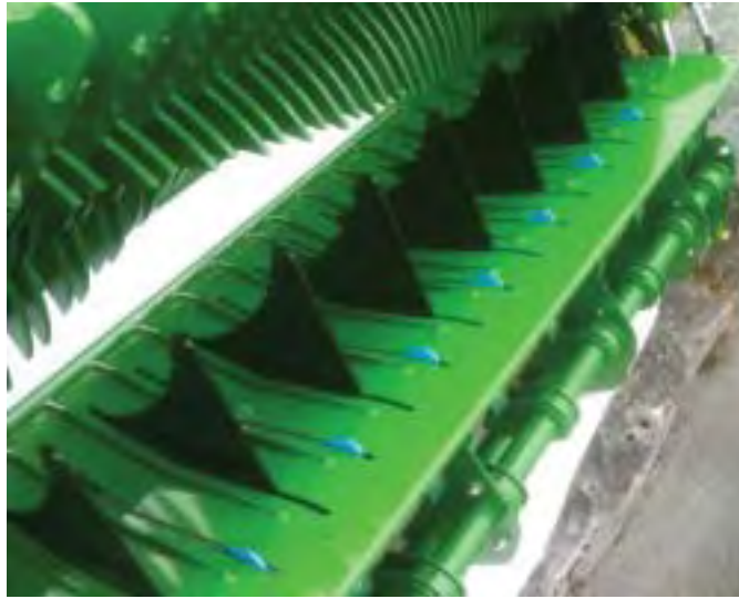
Kuva 11.b - Valittavilla terillä varustettu silppuri
