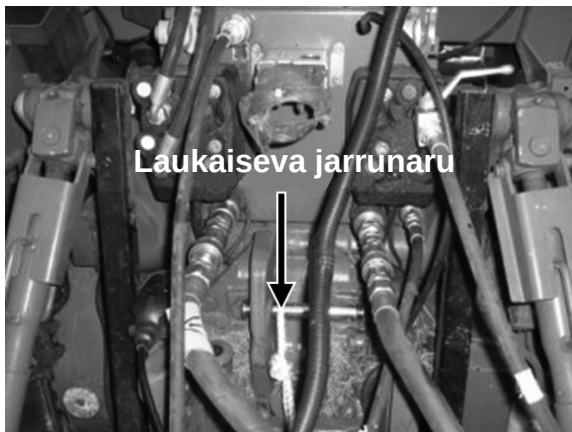
Kuva 9.b - Laukaiseva jarrunaru kiinnitettynä traktoriin
