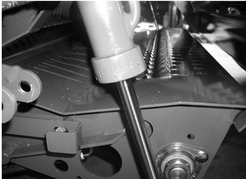
Kuva 10.d - Tukoksenpoistotila, terät vetäytyneinä ja kuilun pohja laskettuna
