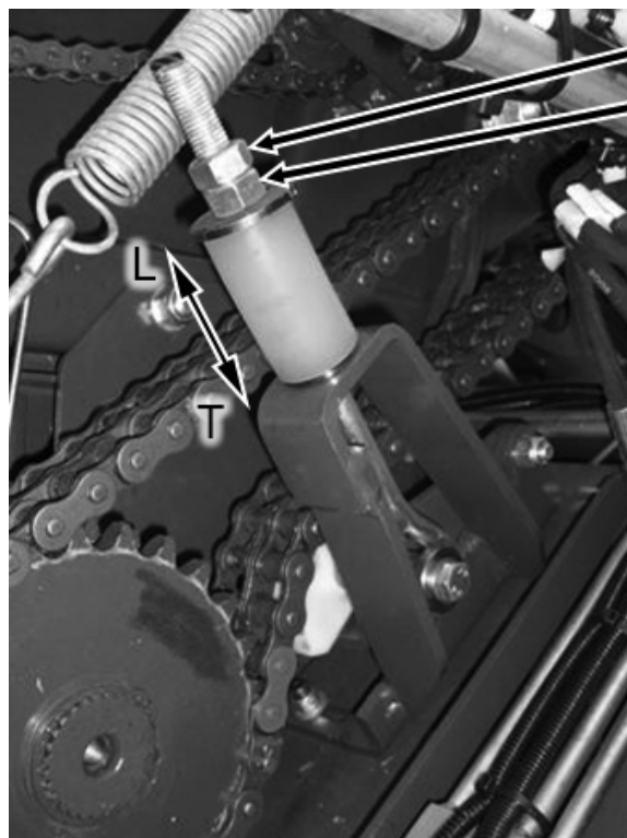
Kuva 10.q - Silppurin kaksirivisen ketjun säätö
