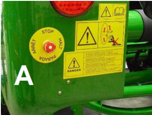
Vasemman takapaneelin vasemmassa takakulmassa sijaitseva pysäytyskytkin A
