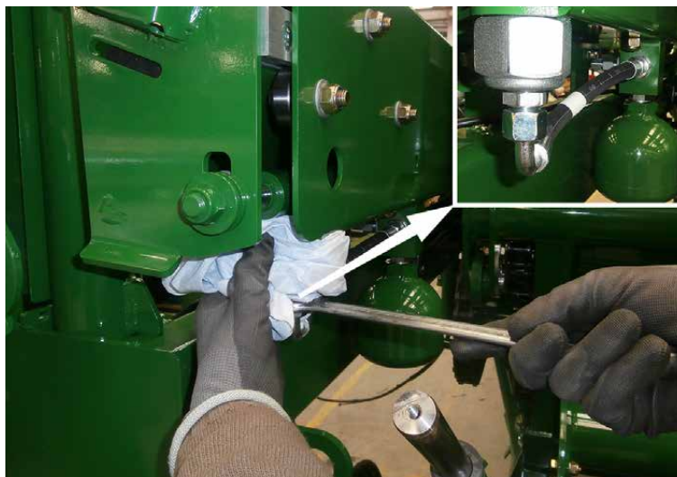
Kuva 8.i – Vapauta hydraulinen paine akuista
