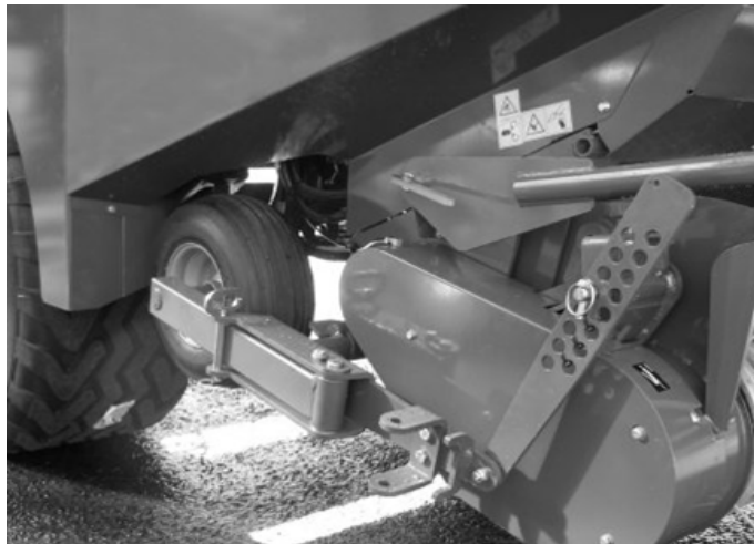
Kuva 9.a – Maantiekuljetusasento (tukipyörien nostaminen)
