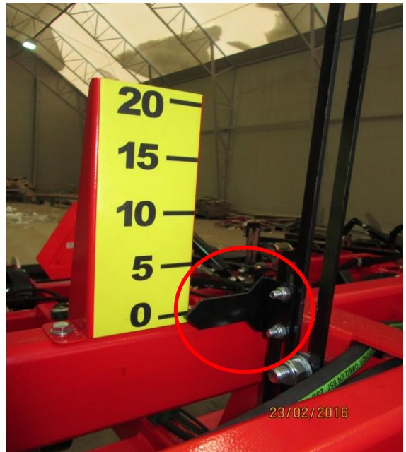
Kuva 10. Työsyvyysmittari sijaitsee äkeen keskilohkon päällä.
