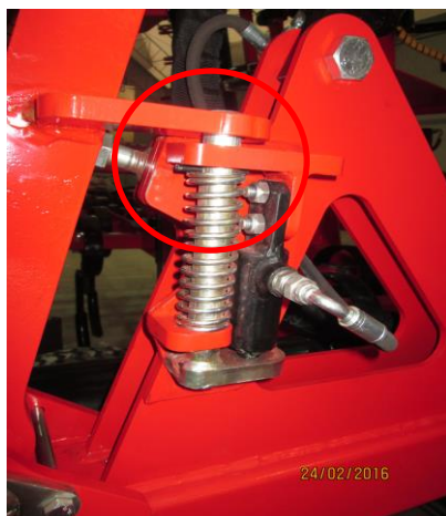
Kuva 3. Sivulohkojen mekaaninen lukitus kiinni asennossa.
