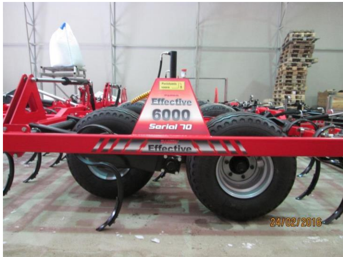
Kuva 7. Koneen säätö vaaka-asentoon. Punaisella ympyröity työntövarsi ja vieressä äes vaakatasossa
