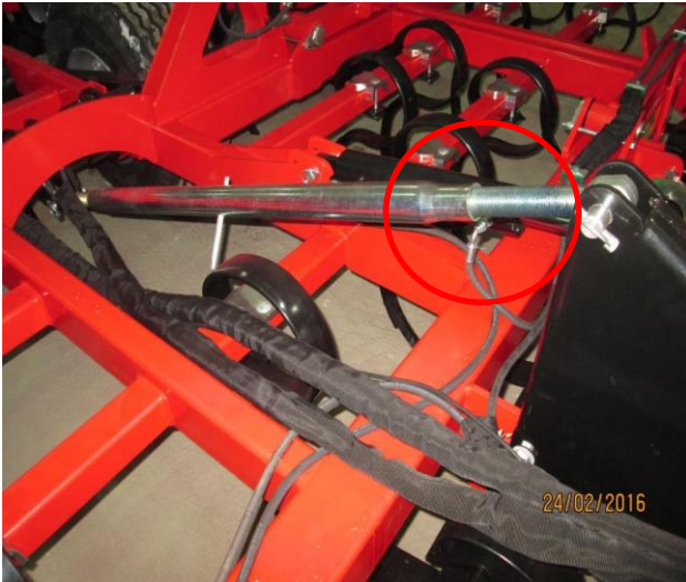
Kuva 7. Koneen säätö vaaka-asentoon. Punaisella ympyröity työntövarsi ja vieressä äes vaakatasossa
