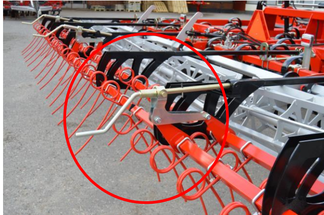
Kuva 14. Portaaton säätö 2-rivinen Jälkihara.
