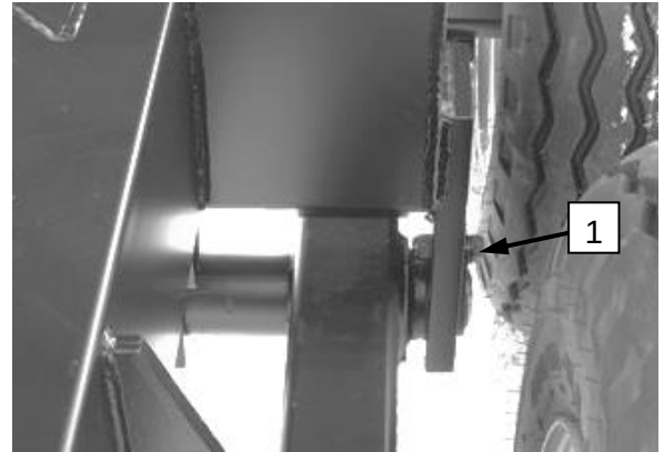
1. Teliakselinpultti ja mutteri (yksi pultti per puoli)
