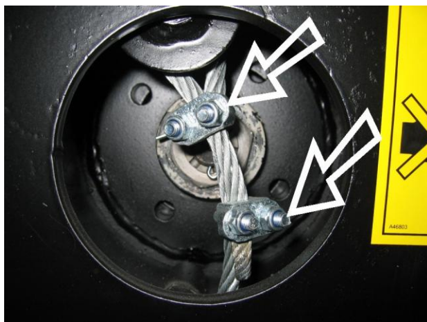
Kuva 3. Vaijerikiinnikkeiden sijainti rummun sisällä.
