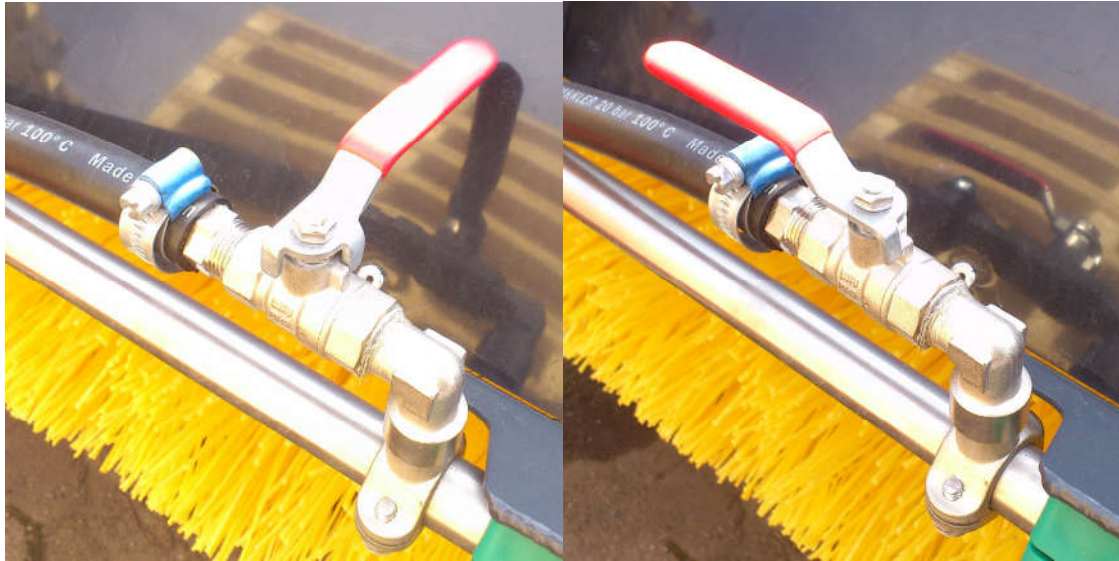
Kuva 6. Pallohana oikealla suljetussa ja vasemmalla avatussa asennossa
