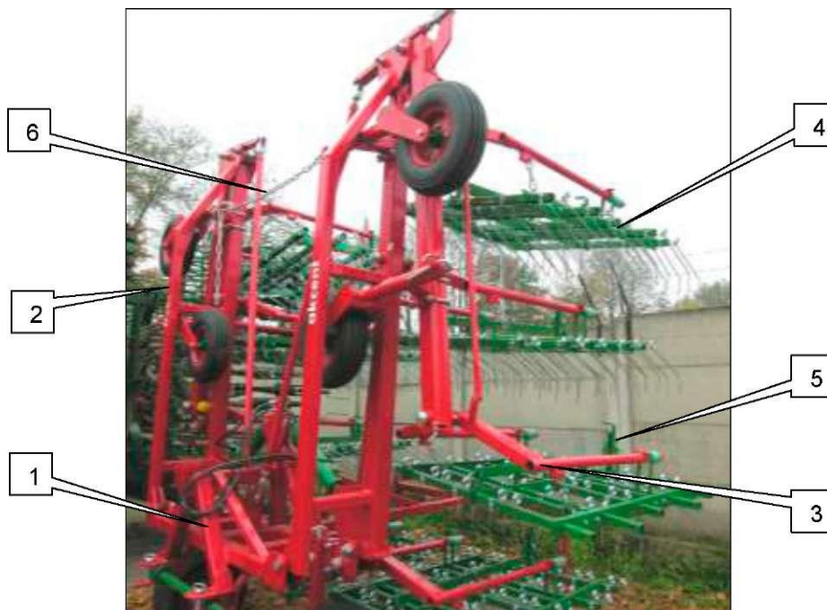
Kuva 5.1. Kitkijän komponentit (1 - runko, 2 - työvarret, 3 - kiinnitystelineet, 4 - äkeet, 5 - äkeiden työkulman säätö, 6 - ketju (kuljetusaikainen turvalaite)).
