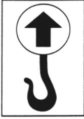
Nostovälineen koukkujen kiinnityspaikat
