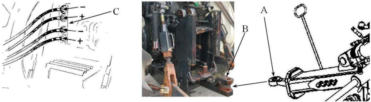
Kuva 8 Hinattavan koneen kiinnittäminen
