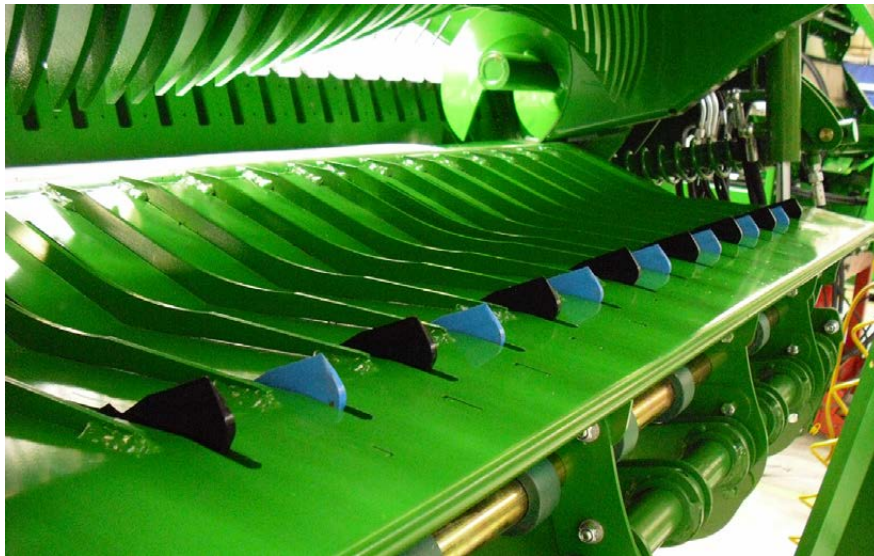
Tukoksenpoistotila, terät vetäytyneinä ja kuilun pohja laskettuna
