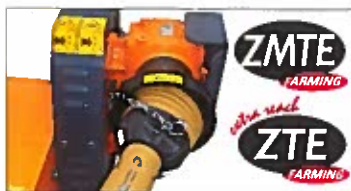
Gruppo moltiplicatore esterno alla trasmissione. Gearbox is fitted outside the transmission cover. Grupo reductor externo a la transmisión. Getriebe außerhalb der Übertragungsgruppe.
