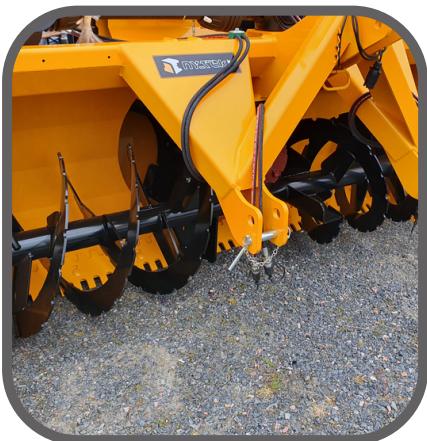
Syöttökierukka 400HB Hardox (malli 260R)
