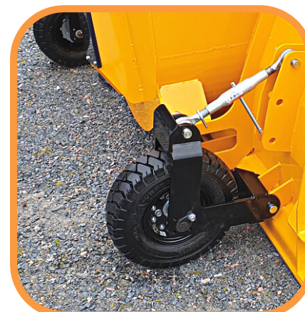
Tukipyörät 5.00-8, mekaanisesti säädettävä korkeus. Sarja 2 kpl.
