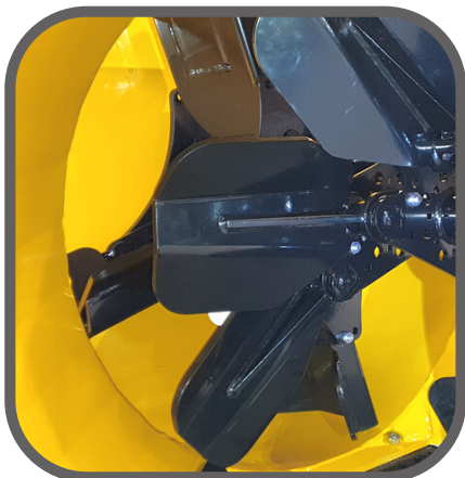
Vahvarakenteinen heittosiivikko murtopulteilla (mallit 241, 242 ja 260R)
