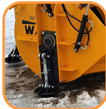
Säädettävät tukijalaket 500HB Hardox (malleissa 241, 242 ja 260R vakiona)
