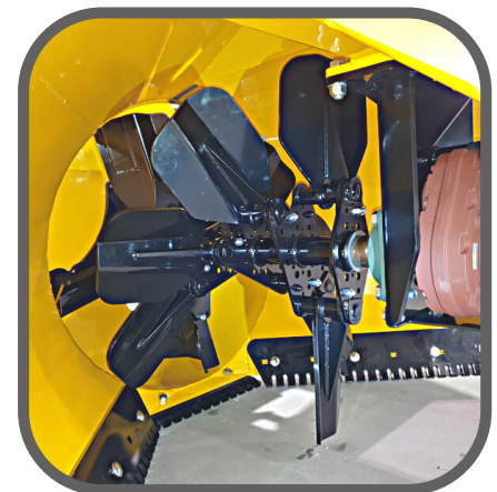
Tehokas laparottori murtopulteilla. Lavat 500HB Hardox (mallit 241 ja 242)
