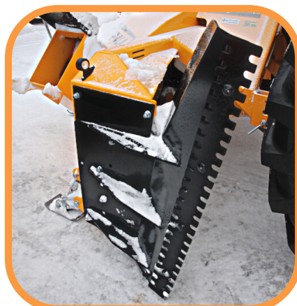
Vallileikkuri 500HB Hardox terällä (malleihin 241, 242 ja 260R)
